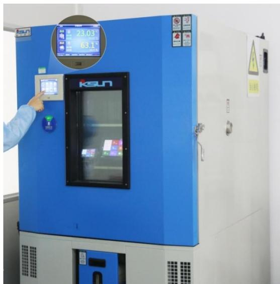
图 5-3 高低温老化测试图
